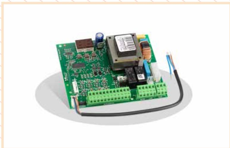
Incorporata nei motoriduttori Falcon M5 ENC, Falcon M8 C ENC, Falcon M14 C, Falcon M20 C, Blizzard 500 C ENC e Blizzard 900 C ENC.
